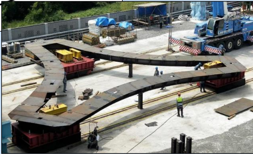
轉接段之移動式噴塗治具
